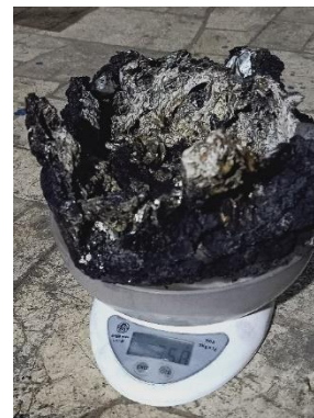
Gambar 4.5 hasil residu proses pirolisis sachet kopi
