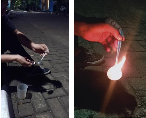
Gambar 4.10 Uji coba membakar minyak pirolisis
