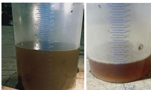
Gambar 4.7 Hasil minyak pirolisis dengan massa 1000 gram
