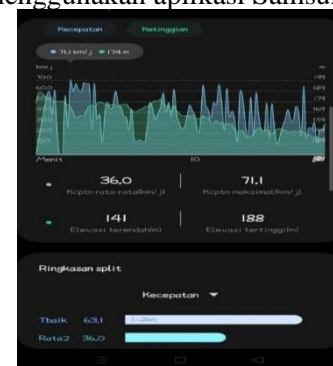
Gambar 4.4 Pengukuran Kecepatan Menggunakan Aplikasi Samsung Health
