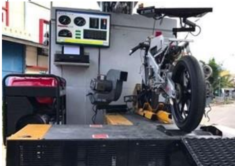
Gambar 3. Pengujian menggunakan dynozet
