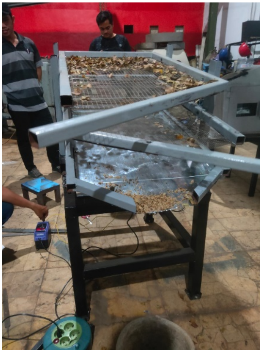
Gambar 6. Proses pengayakan menggunakan alat pemisah pakan BSF
