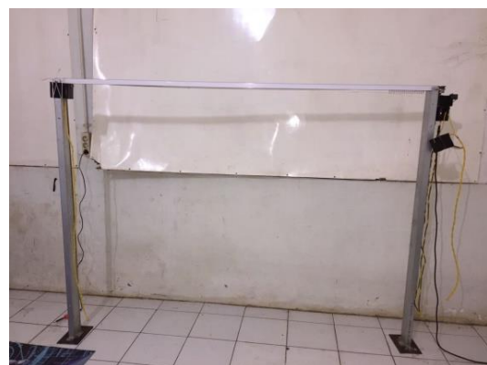
Gambar 12. Bentuk fisis rancangbangun pengendali motor ac 1 fasa sebagai penggerak jemuran otomatis
