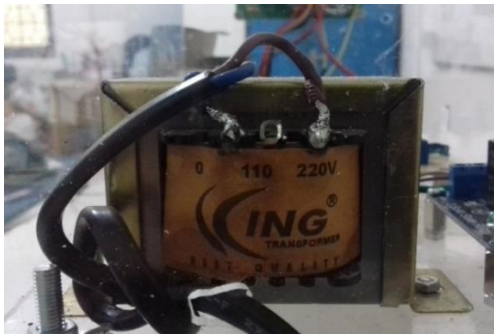
Gambar 8. Pemasangan Transformator tampak depan pada sistem utama
