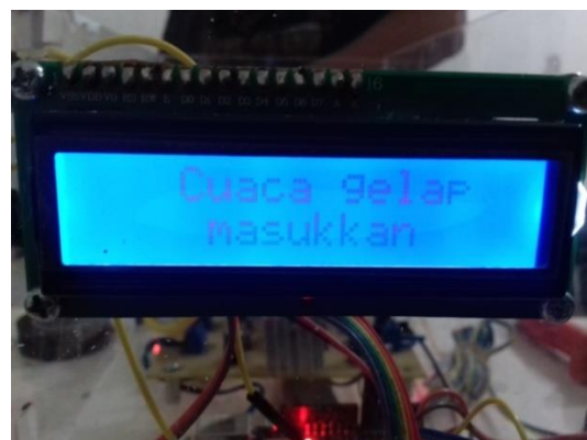
Gambar 15. Keterangan hasil percobaan rancangbangun pengendali motor ac 1 fasa sebagai penggerak jemuran otomatis pada saat cuaca gelap
