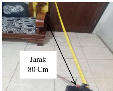
Gambar 4. Hasil Pengujian Sensor Ultrasonik kondisi Jarak 80 Cm
