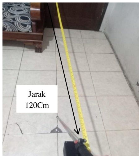
Gambar 5. Hasil Pengujian Sensor Ultrasonik kondisi Jarak 120 Cm
