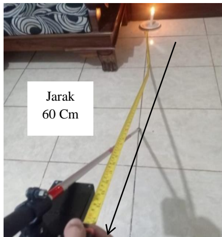
Gambar 6. Hasil Pengujian Sensor Apikondisi Jarak 60 Cm
