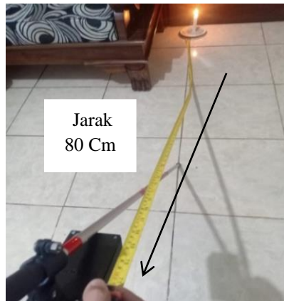
Gambar 7. Hasil Pengujian Sensor Api kondisi Jarak 80 Cm
