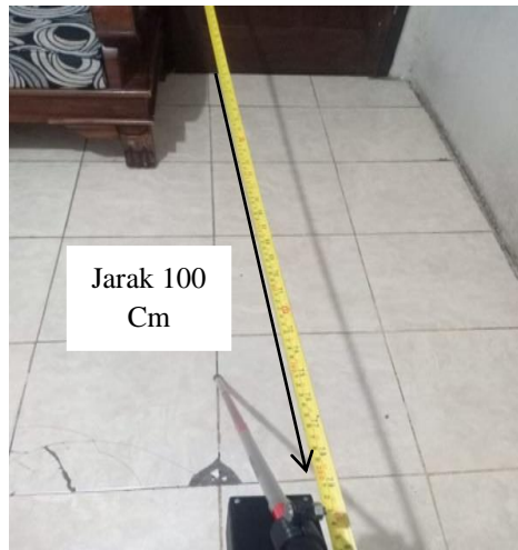
Gambar 5. Hasil Pengujian Sensor Ultrasonik kondisi Jarak 100 Cm
