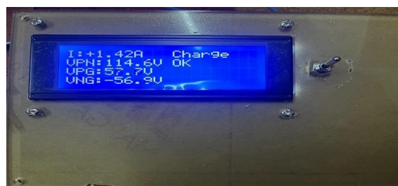
Gambar 8. Tampilan sistem pada saat pengukuran kinerja baterai dalam kondisi charging
