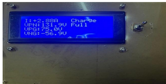
Gambar 10. Tampilan sistem pada saat pengukuran kinerja baterai dalam kondisi full charging
