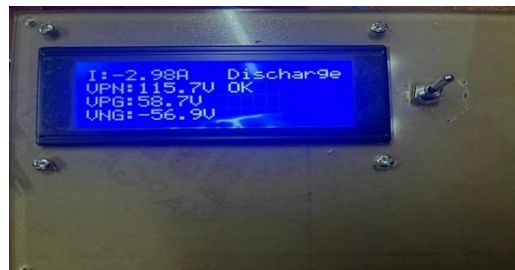
Gambar 4. Tampilan sistem pada saat pengukuran kinerja baterai dalam kondisi discharging
