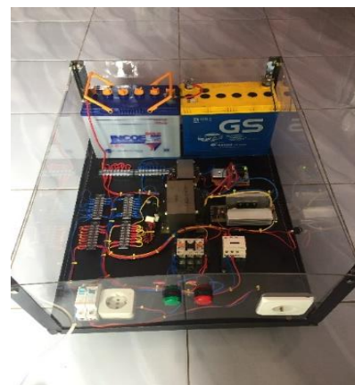
Gambar 13 Bentuk Fisis Desain Rancang Bangun System Emergency Energi listrik
