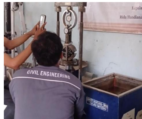
Gambar 10. Pengujian Marshall Penelitian dengan lima variasi kadar aspal menghasilkan nilai stabilitas, VIM, VFA, VMA, Flow, dan Marshall Quotient. Hasil pengujian dapat dilihat pada Tabel 7 dan 8.
